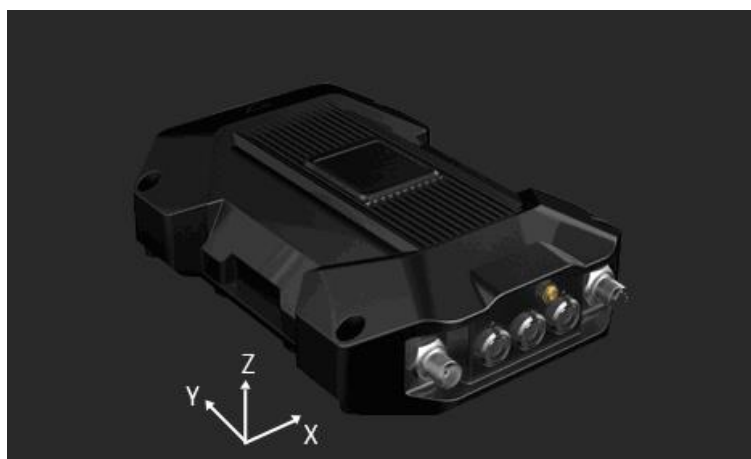
图3-1 考易考机体坐标系示意图
